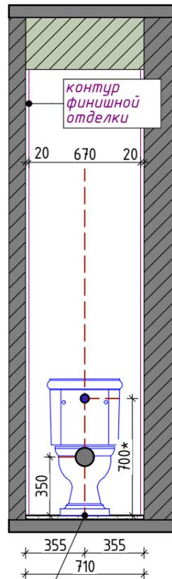
\* Ось подключения напольного унитаза (подключение согласно тех. карте)
