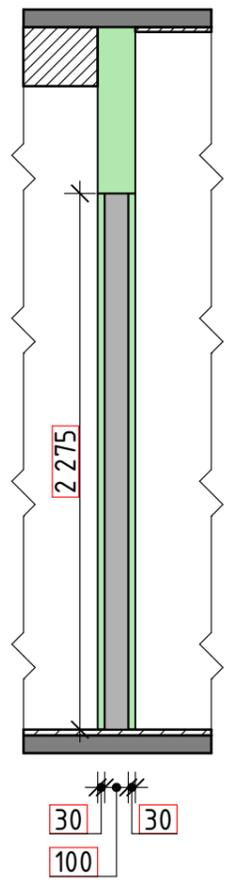
**Каркас универсальный для установки раздвижных дверей**
