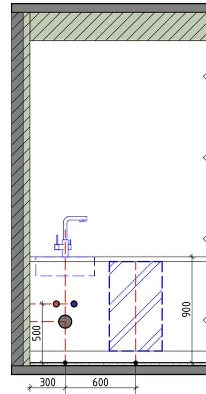
\* Ось подключения врезной мойки (подключение согласно тех. карте)
