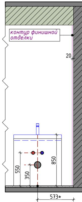
\* Ось подключения раковины (подключение согласно тех. карте)
