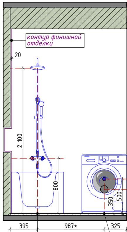
\* Ось подключения душевой стойки со смесителем с ручным душем (подключение согласно тех. карте)
